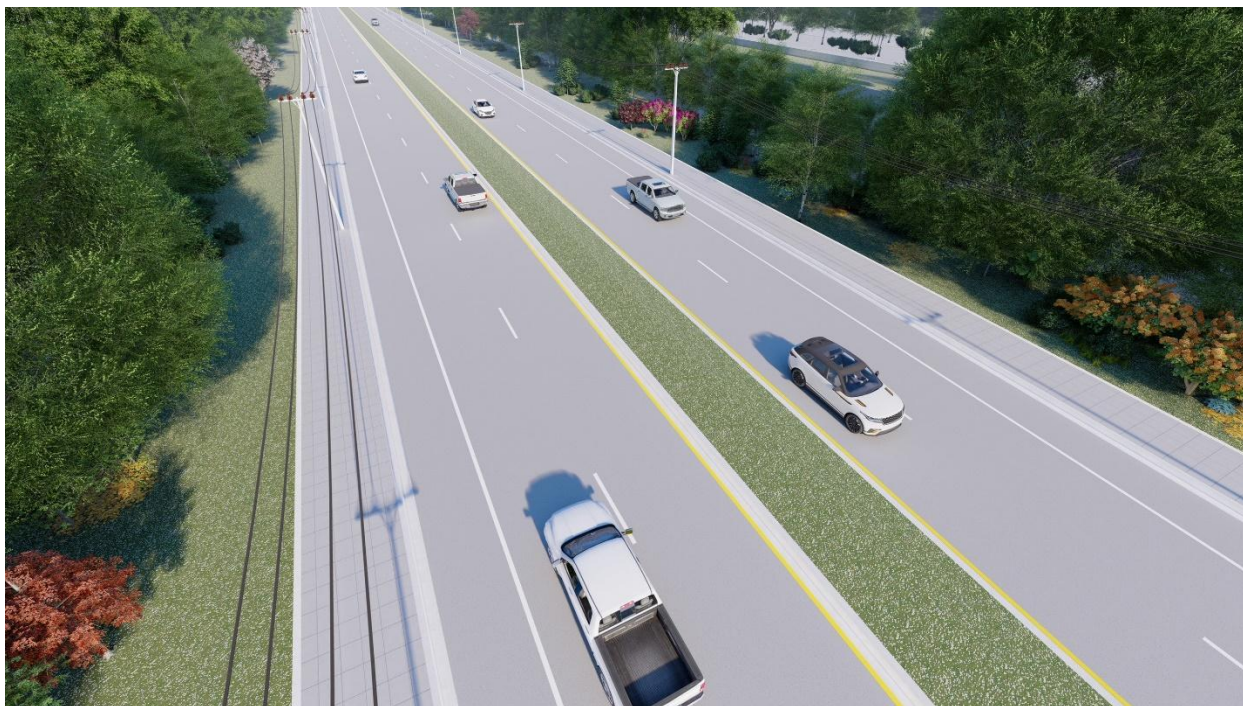
รูปที่ 5.2-12 (ต่อ) เกาะกลางแบบยก (Raised Median) สำหรับทางหลวงหมายเลข 12 ช่วงเขตทางกว้าง 30 เมตร
