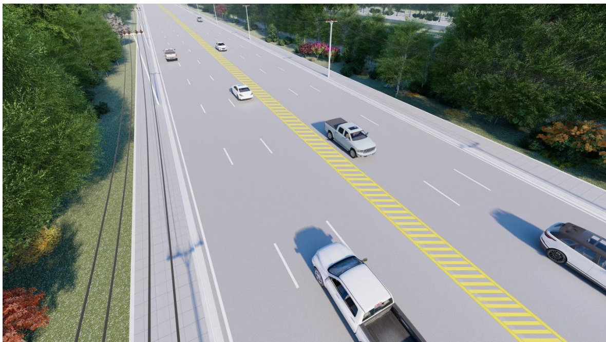
รูปที่ 5.2-6 (ต่อ) เกาะกลางแบบเกาะสี่ สำหรับทางหลวงหมายเลข 12 ช่วงเขตทางกว้าง 30 เมตร
