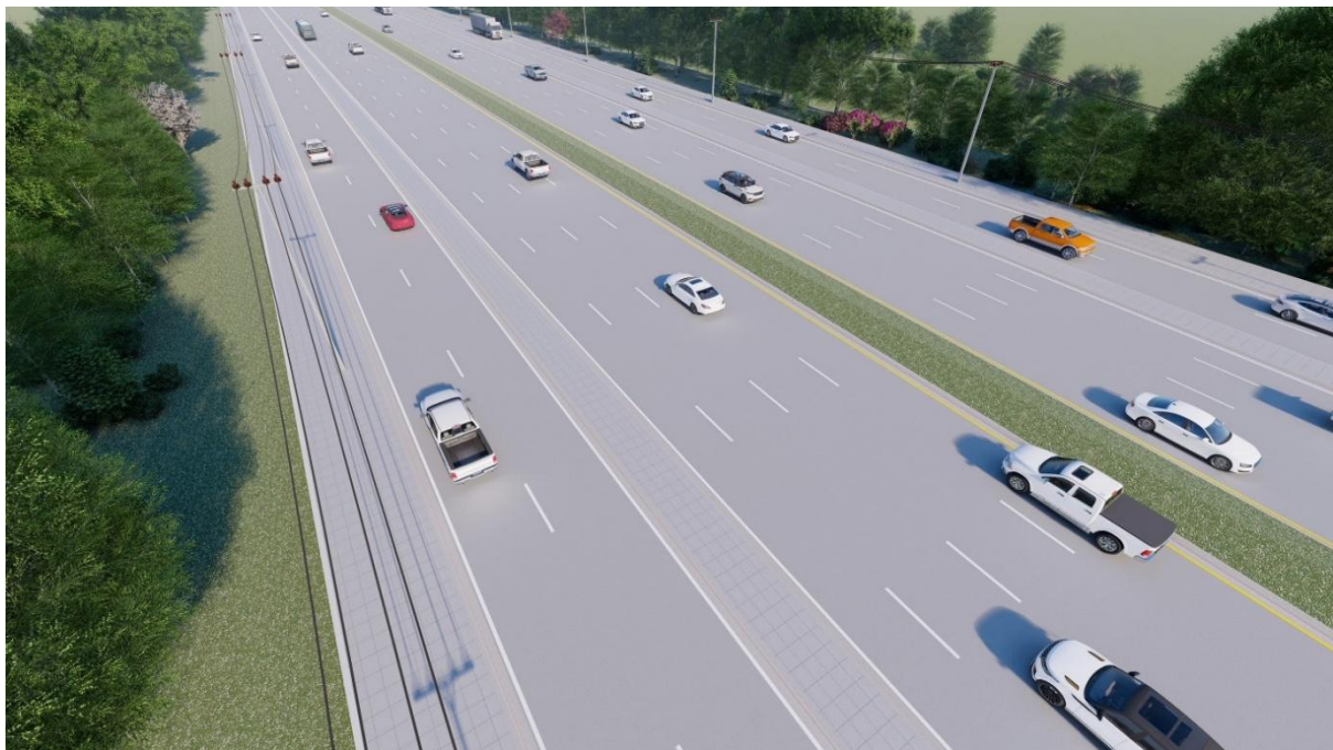
รูปที่ 5.2-14 (ต่อ) เกะกลางแบบยก (Raised Median) สำหรับทางหลวงหมายเลข 101 และ 1293 ช่วงเขตทางกว้าง 60 เมตร
