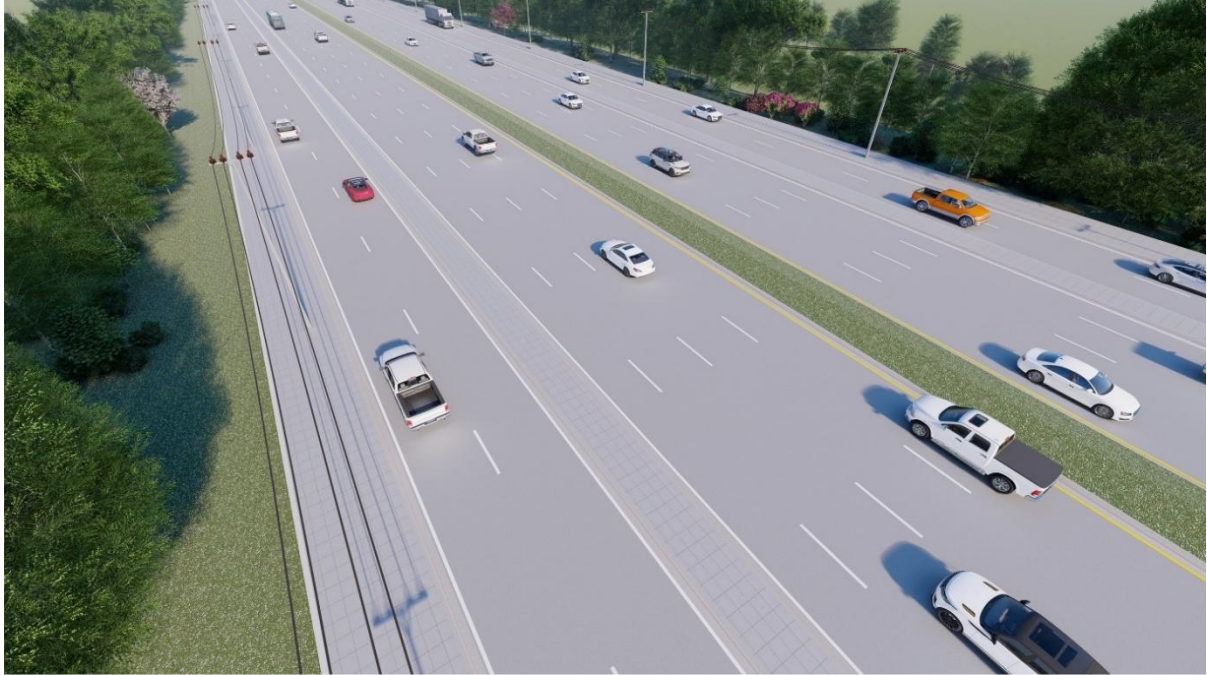
รูปแบบที่ 3 (ต่อ) เกาะกลางแบบยก สำหรับทางหลวงหมายเลข 101 และทางหลวงหมายเลข 1293 ช่วงเขตทางกว้าง 60 เมตร
