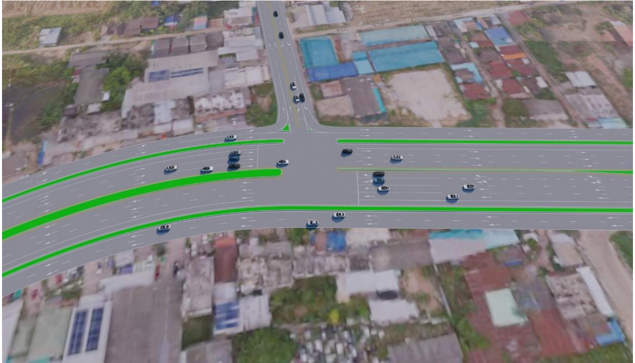
รูปที่ 5.4-2 รูปแบบเบื้องต้น ทางแยกยกระดับพื้น ทางหลวงหมายเลข 101 กม.ที่ 81+864 (แยกไปอุทยานประวัติศาสตร์ศรีสัชนาลัย)
