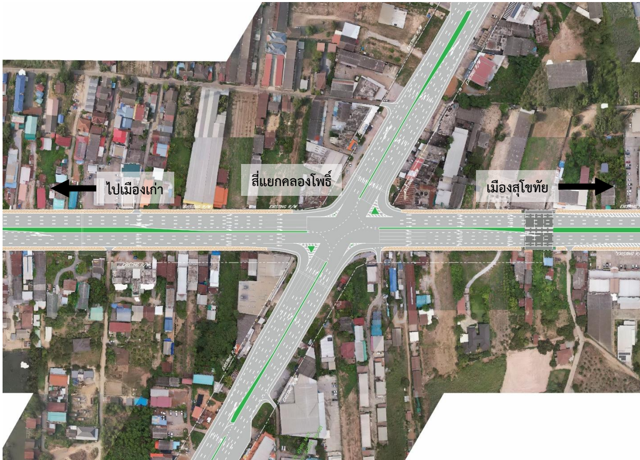
รูปที่ 5.4-1 รูปแบบทางแยกระดับพื้นทางหลวงหมายเลข 12 กม.ที่ 171+282 (แยกคลองโพธิ์)
